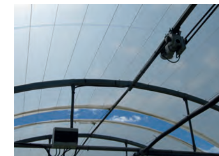
Separación de las lonas mediante cable y torno
